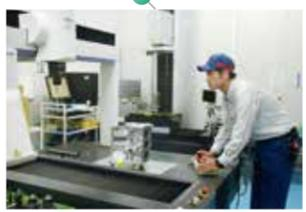
専用の機械に必要項目を打ち込み、コントローラーで操作
