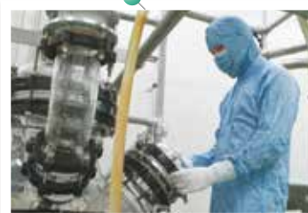
ガラス反応装置を使って原料の胎盤から プラセンタ成分を抽出します
