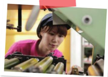
印刷がずれてしまうと大変です。稼働中も目を離さずに、用紙やインクの状況などをチェックしながら機械を動かします。
